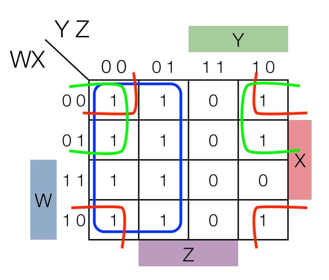
$\overline{Y} + \overline{W}\overline{Z} + \overline{X}\overline{Z}$
